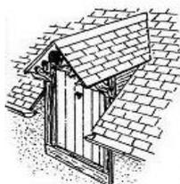
**Rampante (ou chien couché) :** Lucarne dont le toit possède un seul versant, incliné dans le même sens que la toiture du bâtiment mais avec une pente plus faible.
