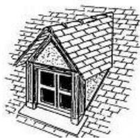
**Pendante, passante ou à foin :** Lucarne à l'aplomb de la façade, interrompant l'égout du toit et descendant légèrement sur la façade.
